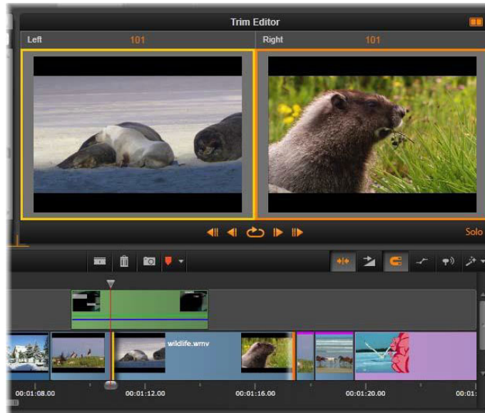
L'éditeur de coupure dans une opération de coupure par glissement. L'aperçu de gauche montre le point de coupure actuellement sélectionné et celui de droite montre le second point de coupure.
